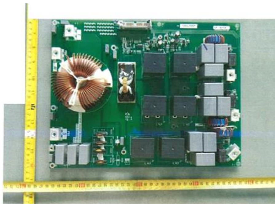
图 9 (AC 输出板正面)
